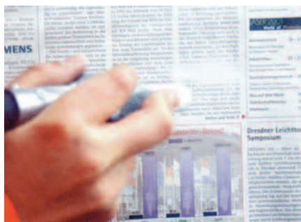
Schonende Reinigung: Die gedruckten Buchstaben verschwinden, das Zeitungspapier bleibt unbeschädigt
