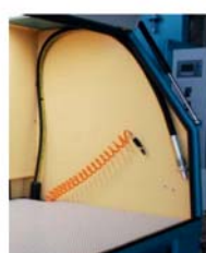
Strahlraum mit Frontklappe, Gitterrost, Innenraumbeleuchtung, Strahldüse und Luftausblaspistole
