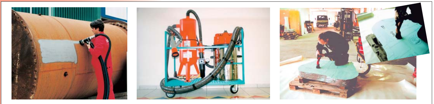
SAPI Rücksaugstrahlgeräte „staubfreies Strahlen“ SAPI Recycling Sandblasting Machine „Dustfree-Blasting“
